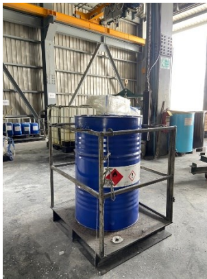
รูปถ่ายที่ 3.2-30 : โครงเหล็กกันถังเคมีขณะเคลื่อนย้าย
